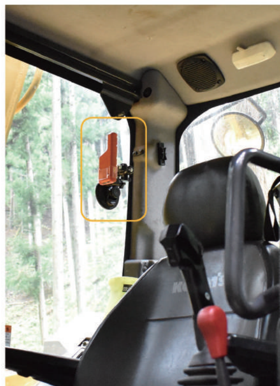
GoPro規格のマウントを活用しGeoChatを高性能林業機械に取り付けている様子
