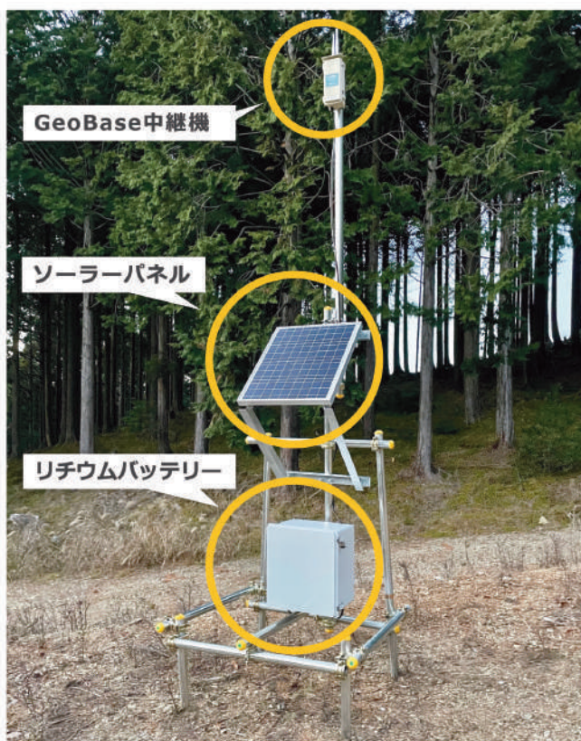
GeoBase Multi Repeater (6ポートタイプ中継機) 設置事例
